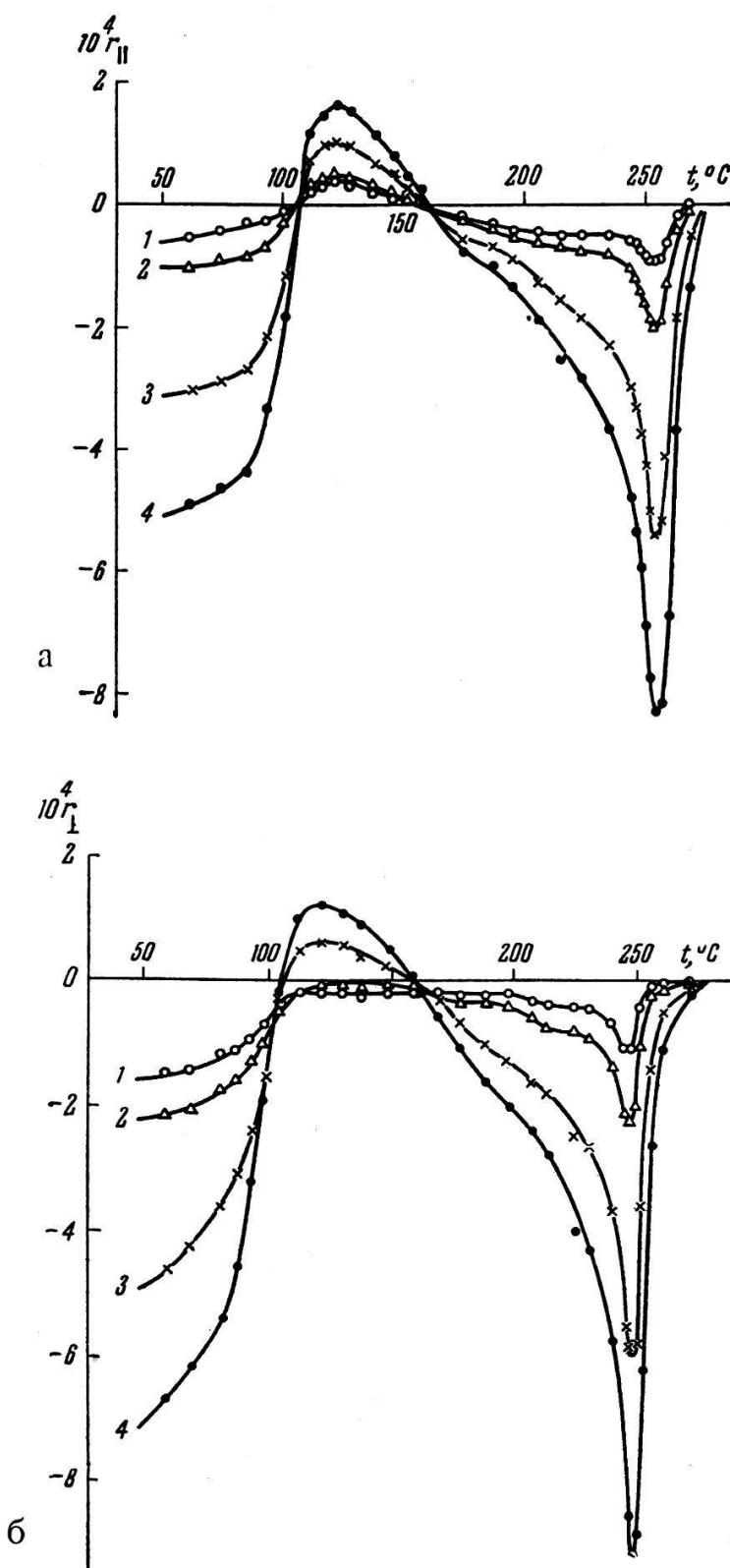
Фигура 3. Гальваномагнитные эффекты в феррите  $\text{Li}_2\text{O} 2,7 \text{Fe}_2\text{O}_3 2,3 \text{Cr}_2\text{O}_3$ : а- продольный, б- поперечный эффект 1-1,08 кОе, 2-2,26 кОе, 3-6,8 кОе, 4-11 кОе.
