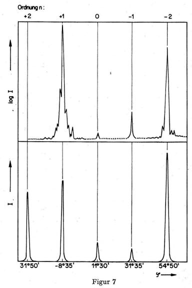
Oben: Messungen am Modell im Mikrowellengebiet ( $\lambda=3$  cm) der Beugungsordnungen eines Echelettegitters mit d=4,48 cm. Unten: Messungen der Beugungsordnungen eines Echelettegitters der Gitterkonstanten  $d=500~\mu$  mit Hilfe der  $\lambda=337~\mu$ -Strahlung des Lasers. Für beide Messungen beträgt der konstante Ablenkwinkel  $\phi=24^{\circ}$ .
