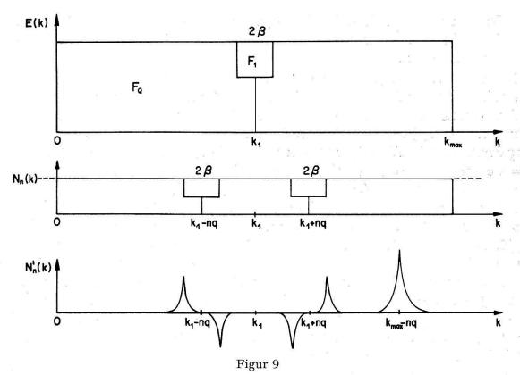
Effekt einer Verstärkungsschwankung im rücktransformierten Spektrum. E(k): vorgegebenes Spektrum;  $N_n(k)$  und  $N_n'(k)$ : Störungen, die sich nach Rücktransformation E(k) überlagern.
