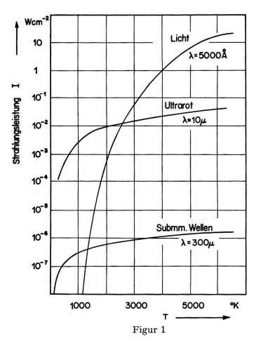
Strahlungsleistung des schwarzen Körpers in Funktion der Temperatur für drei charakteristische Wellenlängen bei der spektralen Bandbreite  $\lambda/\Delta\lambda=100$ .
