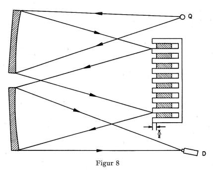
Strahlengang des Laminargitter-Interferometers. x: variable Furchentiefe, Q: Quelle, D: Detektor.
