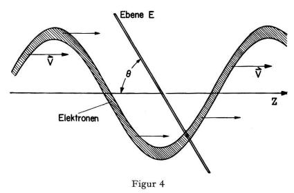
Schlangenförmiger Elektronenstrahl, der vom Ablenkungsmodulator erzeugt wird. Schraffur: Elektronen;  $\boldsymbol{v}$ : Geschwindigkeit der Elektronen;  $\boldsymbol{\theta}$ : Winkel zwischen der z-Achse und der fiktiven Ebene E.
