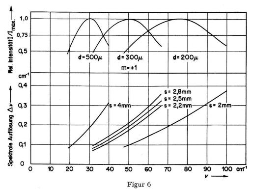
Oben: Relative Intensitätsverteilung der Beugung an Monochromatorgittern mit den Furchenabständen  $d=500,\,300\,\mathrm{und}\,200\,\mu$ . Unten: Theoretische, spektrale Auflösung  $\Delta v$  des selbstgebauten Monochromators für typische, experimentelle Spaltbreiten s.
