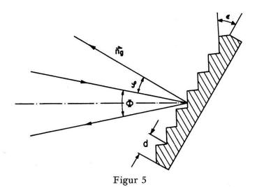
Daten des Echelette-Gitters.  $n_g$ : Normale zur Gitterebene; d: Gitterkonstante;  $\phi$ : Konstanter Ablenkwinkel und Einfallswinkel der Strahlung.
