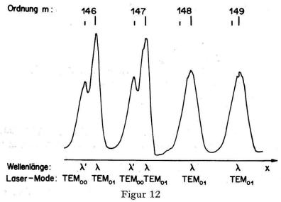
Ausschnitt aus dem Fabry-Pérot-Interferogramm der CH<sub>3</sub>SCN-Laserstrahlung. Laser-Betriebsbedingungen: 0,15 Torr CH<sub>3</sub>SCN, 6 Pulse von 20 KV pro sec Resonatorlänge 3,63 m<sup>2</sup>).
