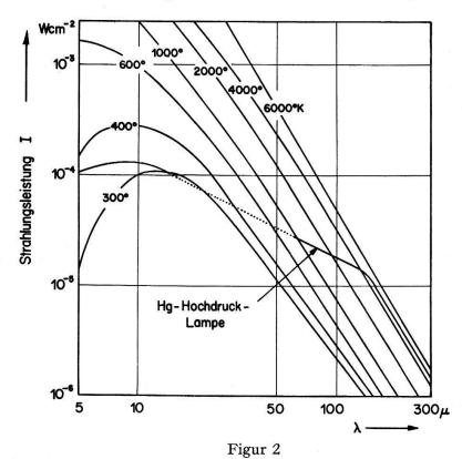
Das Bogenkontinuum des Hg-Hochdruckbrenners (nach Вондалякі [5]) im Vergleich zur Strahlungsleistung des schwarzen Körpers. Bandbreite  $\lambda/\Delta\lambda=100$ .
