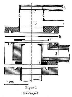
Rechte und linke Hälfte der Zeichnung zeigen zwei um 90° gegeneinander versetzte Schnitte. Es bedeuten: 1 Gegenspannungselektrode. 2 Erster Folienträger. 3 Heliumkreislauf. 4 Einsatz zur Begrenzung der He-Strömung auf 5 mm Breite. 5 Zweiter Folienträger. 6 Tritiumgas (Länge des Behälters 20 mm). 7 Au-Pd-Folie. 8 Wasserkühlung.
