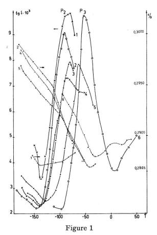
Frottement intérieur et fréquence propre  $\nu$ , en fonction de la température, mesurés sur un fil d'or polycristallin, recuit dans l'installation pendant 4h à 400 °C puis écroui 4 tours en torsion.
