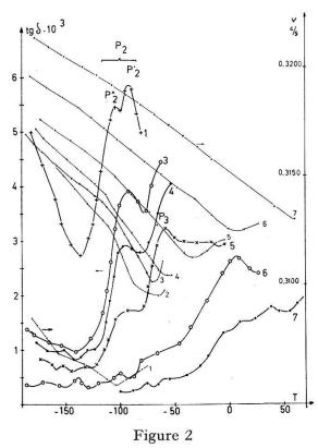
Frottement intérieur et fréquence propre  $\nu$ , en fonction de la température, mesurés sur un fil d'or monocristallin, d'axe cristallographique [111] dans l'axe du fil, recuit dans l'installation pendant 4h à 400 °C, puis écroui 3 tours en torsion.
