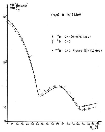
Distribution angulaire de la section efficace de diffusion élastique pour le <sup>10</sup>B et le <sup>11</sup>B.
