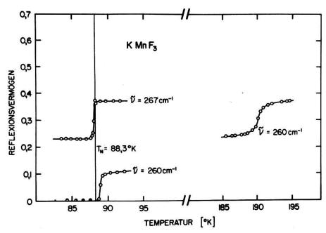
Reflexionsvermögen von KMnF<sub>3</sub> in Funktion der Temperatur für zwei feste Frequenzen der Seitenbande.
