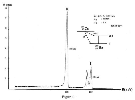
$^{137}_{55}\text{Cs-Spektrum}$ bei einem Quellenpotential  $U_s=0$  V.
