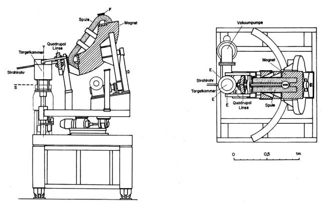
$\label{eq:Figur 1} Figur \ 1$  Magnetisches Spektrometer.
