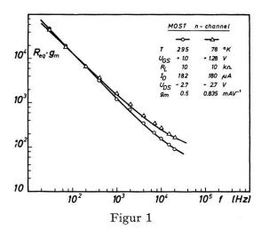
Rauschspektren eines n-Kanal-MOS-Transistors bei 295°K und 78°K.
