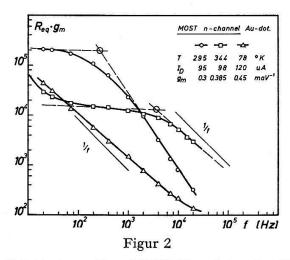
Rauschspektren eines golddotierten n-Kanal-MOS-Transistors bei 295°K, 344°K und 78°K.
