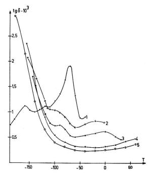
Frottement interne d'un échantillon d'or écroui et irradié.
