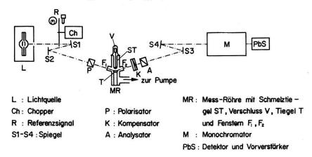
Aufbau der Apparatur (schematisch).
