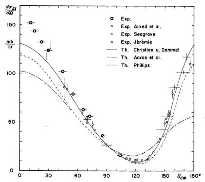
Differentieller elastischer Wirkungsquerschnitt im Schwerpunktsystem.
