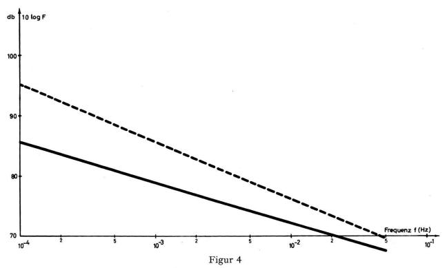
Rauschspektren des 2 N 4044 vor und nach der Bestrahlung. — Vor Bestrahlung,  $I_C=0.1$  mA,  $\varkappa=0.65\pm0.03$ . — Nach Bestrahlung,  $I_C=0.1$  mA,  $\varkappa=0.95\pm0.02$ .
