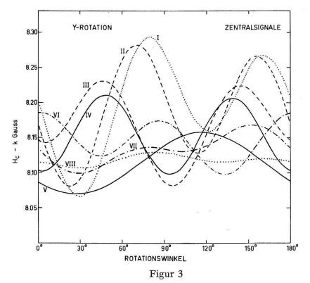
Winkelabhängigkeit der Positionen  $H_c$  der acht  $^{27}$ Al-Zentralsignale im Anorthit a) für die X-Rotation b) für die Y-Rotation. Bei fehlender Quadrupolwechselwirkung würde das  $^{27}$ Al-Signal bei 8,11 kG erscheinen.
