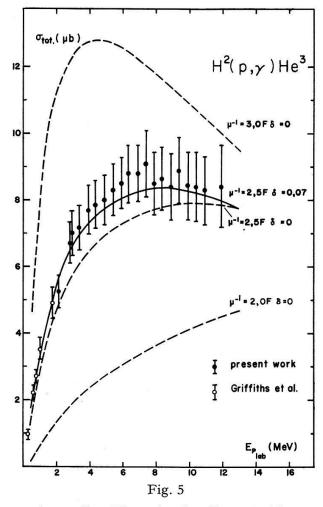
Zusammenstellung der experimentellen Werte für den Gesamtwirkungsquerschnitt der Reaktion  $H^2(p,\gamma)He^3$ . Die verschiedenen Kurven wurden unter Berücksichtigung des Gunn-Irvingschen Ansatzes für die Wellenfunktion des Grundzustandes und der Coulombwechselwirkung zwischen dem Proton und dem Deuteron im Kontinuumszustand berechnet.
