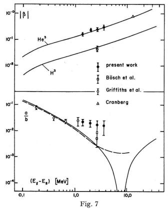
Vergleich der experimentellen und theoretischen Werte für die Koeffizienten der Winkelverteilung  $\beta$  und a/b. Die ausgezogenen Kurven wurden mit dem Gunn-Irvingschen Ansatz und den Parameterwerten  $\mu^{-1}=2.5$  F,  $\delta=0.07$  ohne Berücksichtigung der Wechselwirkung im Kontinuumszustand berechnet. Die gestrichelte Kurve zeigt den Einfluss der zwischen dem Proton und dem Deuteron wirkenden Coulomb- und Kernkräften.
