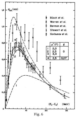
Zusammenstellung der experimentellen Werte für den Gesamtwirkungsquerschnitt der inversen Reaktionen He<sup>3</sup>( $\gamma$ , p)H<sup>2</sup> und H<sup>3</sup>( $\gamma$ , n)H<sup>2</sup>. Nicht eingetragen sind die Resultate von Finckh et al. [32], die mit denjenigen von Stewart et al. [10] und Bermann et al. [9] gut übereinstimmen, sowie diejenigen von Becchi et al. [15] die im Mittel um einen Faktor 2,5 höher liegen. Die Kurven wurden mit denselben Voraussetzungen wie in Fig. 5 berechnet.
