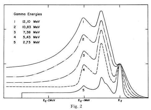
Antwortfunktionen des  $3'' \times 3''$  NaI-Kristalls für monochromatischen breiten Gammastrahl. Zu ihrer Bestimmung wurden Gammalinien der Reaktionen Al<sup>27</sup> $(p, \gamma)$ Al<sup>28</sup> (1), N<sup>14</sup> $(n, \gamma)$ N<sup>15</sup> (2), Pb<sup>207</sup> $(n, \gamma)$ Pb<sup>208</sup> (3) und S<sup>32</sup> $(n, \gamma)$ S<sup>33</sup> (4) benützt. Die tiefste Energie (5) stammt von einer Na<sup>24</sup>-Quelle.
