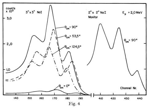
Winkelverteilung der Gammaquanten bei einer festen Protonenenergie  $E_{p}=2\,\mathrm{MeV}$ . Die Intensitäten der bei vier verschiedenen Winkeln ausgeführten Messungen sind auf diejenige des fest unter  $\pmb{\theta}=90^{\circ}$  aufgestellten Monitordetektors normiert. Der Untergrund ist hier noch vernachlässigbar klein. Deutlich sichtbar ist die durch den Dopplereffekt erzeugte Abhängigkeit der Gammaenergie vom Reaktionswinkel.
