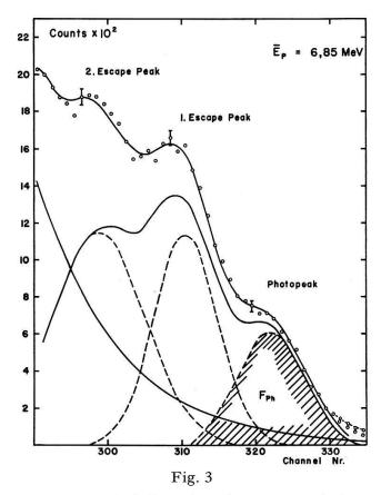
Beispiel einer Einpassung der durch drei Gaussfunktionen approximierten Antwortfunktion mit exponentiellem Untergrund in ein Meßspektrum bei einer Gammaenergie von 10,05 MeV. Die Fläche der Photolinie ( $F_{Ph}$ ) diente als Mass für die auf den Kristall auftreffende Gammaintensität.
