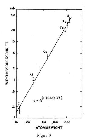
Abhängigkeit des Wirkungsquerschnittes für Spuren von 275–600 MeV vom Atomgewicht des Targets.
