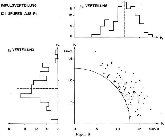
Impulsdiagramm und Verteilungen der Longitudinal- und Transversalimpulse der He-Fragmente aus Blei.
