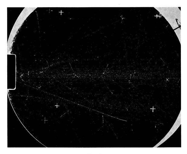
${\bf Figur~1}$  Blasenkammeraufnahme eines He-Fragmentes aus dem Target.
