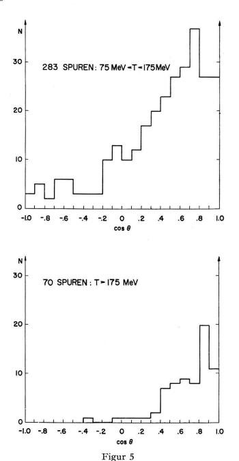
Winkelverteilungen der Spuren aus Freon, separiert für kleine und grosse Energien.
