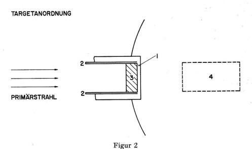
Anordnung des Targets: 1 Strahlfenster (ca. 2 mm Al), 2 Targetfassung (1 mm Al), 3 Target, 4 Scangebiet für Ereignisse mit Entstehungsort in der Flüssigkeit.
