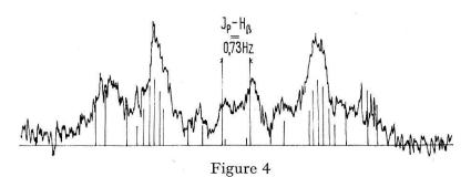
Comparaison du spectre expérimental à 1925 Hz et des spectres calculés du triéthyl thio-phosphate.
