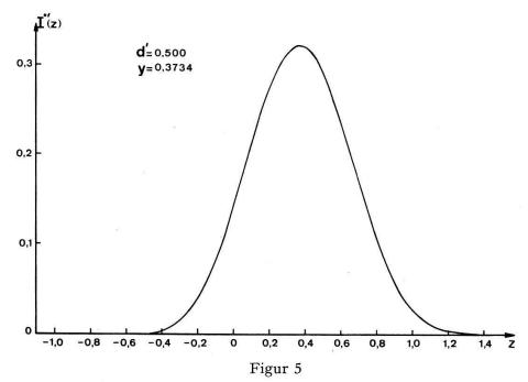
Die von der  $\gamma$ -Energie unabhängige apparative Linienform für optimale Einstellung des Spektrometers.
