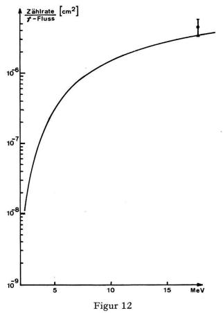
Spektrale Empfindlichkeit für ein Auflösungsvermögen von  $0,27\,\%$  bei optimaler Einstellung des Spektrometers.
