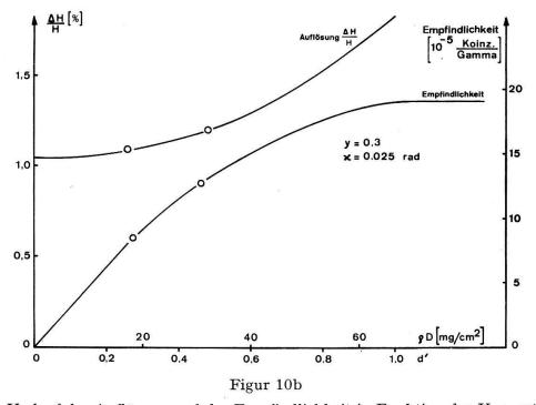
Berechneter Verlauf der Auflösung und der Empfindlichkeit in Funktion der Konverterdicke für Detektorbreiten  $\varkappa=0.015$  rad und 0.025 rad. Die eingetragenen Messwerte wurden bei 17,7 MeV erhalten. Die Grösse des Konverters beträgt in allen Fällen  $30\times36$  mm.
