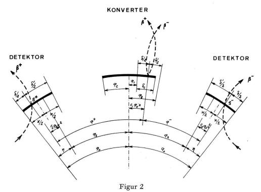
Schematische Darstellung des Spektrometers in der Symmetrieebene  $\alpha=0$  zur Bestimmung der möglichen Startbereiche auf dem Konverter. Für das eingezeichnete Beispiel ist der erlaubte Bereich durch die Koordinaten  $\varphi_1=C_1\,\varphi_s\,x-\delta/2$  und den Konverterrand  $\varphi_c$  gegeben.
