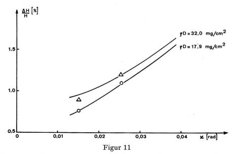
Berechneter Verlauf der Auflösung in Abhängigkeit von der Detektorspaltbreite für die Konverterdicken 17,9 und 32 mg/cm<sup>2</sup>. Die eingezeichneten Punkte entsprechen Messungen bei 17,7 MeV.
