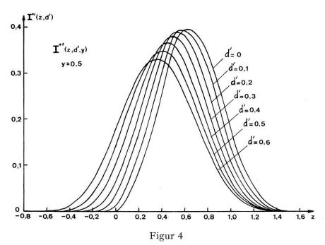
Die Funktion  $I^{*'}(z, y, d')$  repräsentiert bis auf einen konstanten Faktor die apparative Linienform bei endlicher Konverterdicke. Mit zunehmender reduzierter Konverterdicke d' tritt eine Verbreiterung der Linie und eine Verschiebung des Maximums zu niedrigeren Energie auf, während der obere Fusspunkt der Linie fest bleibt und somit einen geeigneten Bezugspunkt für die Energiebestimmung darstellt.
