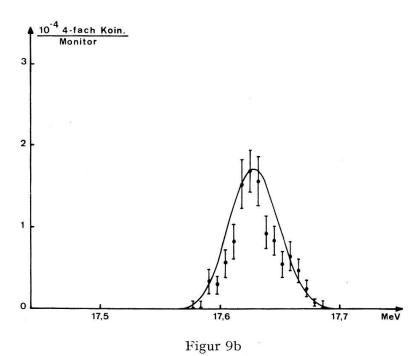
Berechnete apparative Linienformen der 17,64-MeV-Linie der Reaktion Li<sup>7</sup> (p,  $\gamma$ ) Be<sup>8</sup> für Auflösung 0,98% und 0,25%. Die eingetragenen Messwerte zeigen die gute Übereinstimmung zwischen Experiment und Theorie. Die  $\gamma$ -Energie beträgt unter Berücksichtigung der Dopplerverschiebung in der Vorwärtsrichtung 17,7 MeV und entspricht dem oberen Fusspunkt der Linie.
