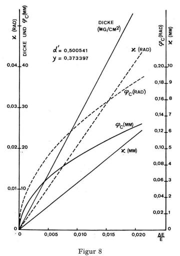
Beziehung zwischen Auflösungsvermögen und den Spektrometerparameter Spaltbreite  $\varkappa$ , halbe Konverterbreite  $\varphi_c$  und Konverterdicke d' für optimale Einstellung. Als Konverter wurde Gold vorausgesetzt.
