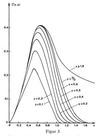
Die Funktion  $I^*(z, y)$  stellt bis auf einen konstanten Faktor die apparative Linienform für einen unendlich dünnen Konverter dar. Die Kurvenschar zeigt, dass die Linienhöhe für Werte y > 2/3 praktisch nicht mehr zunimmt, d. h. eine weitere Vergrösserung des Konverters die Empfindlichkeit nicht mehr erhöht.
