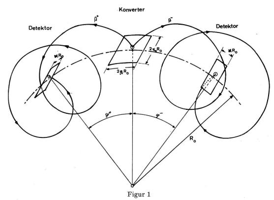
Schematische Anordnung von Konverter, Detektoren und Partikelbahnen im Paarspektrometer.  $\alpha$  ist der Komplementärwinkel zur Koordinate  $\vartheta$  des sphärischen Koordinatensystems  $(r, \vartheta, \varphi)$ :  $\alpha = \pi/2 - \vartheta$ .
