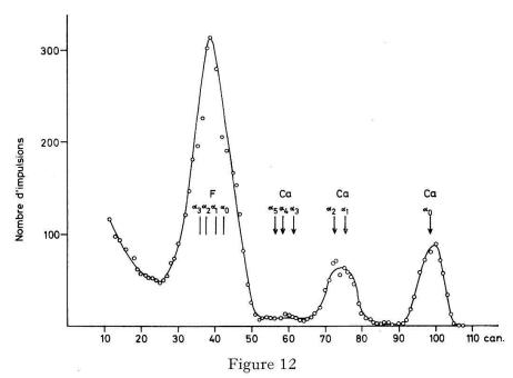
Spectre typique montrant les différents groupes  $\alpha$  (indiqués par des flèches et des traits). L'énergie de chaque groupe est individuellement corrigée pour l'épaisseur de la cible et la perte d'énergie dans le gaz.
