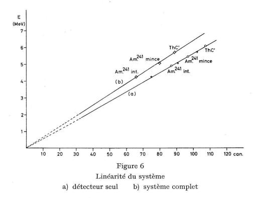
Pour contrôler l'efficacité globale du système, on a encore fait appel à une source de Am<sup>241</sup>, montée sur le porte-cibles dans une position intermédiaire entre deux cibles. En comparant le taux de comptage à la sortie de la porte linéaire à celui provenant directement du détecteur, l'efficacité est facilement déterminée.
