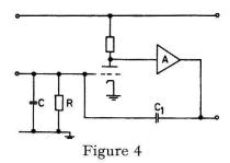
Principe du préamplificateur dans la voie spectrométrique (charge sensitive amplifier)
