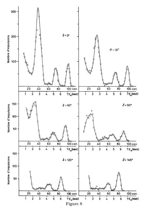
Spectres d'énergie à 6 MeV obtenus avec cible de  $CaF_2$  ( $d = 0.93 \text{ mg/cm}^2$ )
