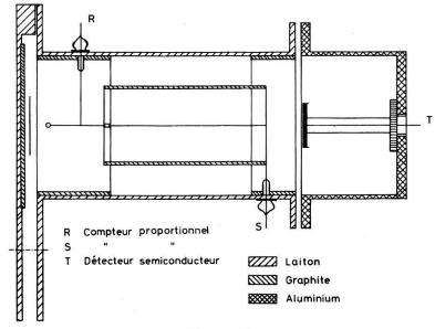
Figure 2 Compteur télescope
