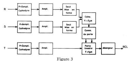
Schéma de principe de l'électronique
