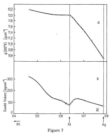
a) densité des cylindres minces (section IIb) par pesée hydrostatique b) dureté Vickers. Les deux courbes en fonction du poids atomique moyen  $\overline{M}$  pour les alliages  $\operatorname{Rh}_x\operatorname{Pd}_{1-x}$  et  $\operatorname{Pd}_x\operatorname{Ag}_{1-x}$  (voir section IV).
