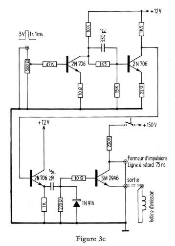
Diagramme schématique du dispositif de mesure avec excitation magnétostrictive.
