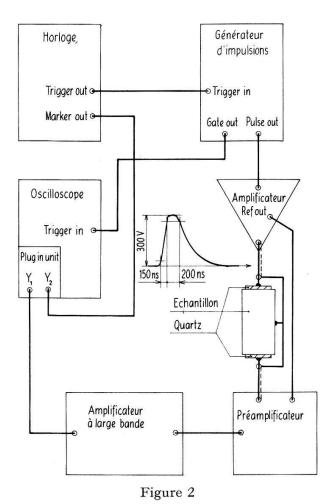
Diagramme schématique pour les mesures par excitation par quartz.
