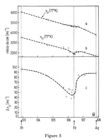
Résultats des mesures par excitation piézoélectrique a) vitesse longitudinale  $v_{l1}$  en m/s (à 77 °K)
