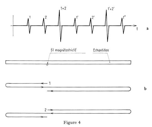
a) Forme d'onde obtenue dans les mesures par excitation magnétostrictive.
