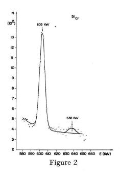
Il s'agit certainement d'un empilement par coincidence fortuite de 2 impulsions engendrées par des quanta de 320 Kev. Nous traiterons ce sujet dans le paragraphe 4.
