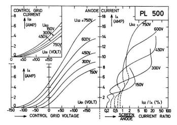
Caractéristiques d'un tube PL 500 moyen (sur 20 échantillons), mesurées en régime pulsé: durée 0,2  $\mu$ s, 50 Hz. Pour autant qu'elle reste > 1 kV, la tension anodique a peu d'influence sur ces courbes (mesurées à  $U_A \approx 1500$  V).
