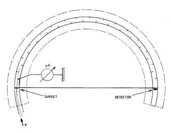
Figur 1 180°-Spektrometer (schematisch).
