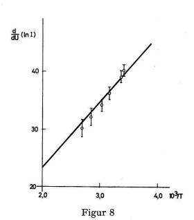
Temperaturabhängigkeit des Exponentialterms der Diodengleichung. Die ausgezogene Gerade gibt den theoretisch erwarteten Verlauf wieder. Ihre Steigung ist gleich q/k.
