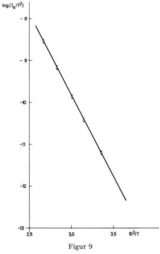
Temperaturabhängigkeit des Sättigungsstroms  $J_s$  (Diode Nr. 7)
