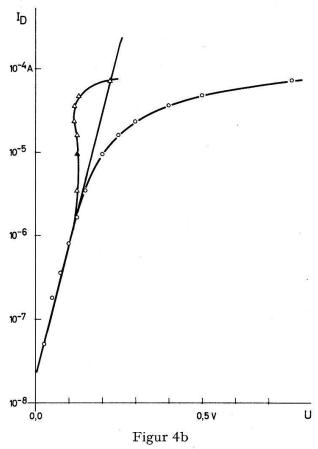
Schutzringstrom, Leitrichtung (Diode Nr. 1)  $\odot$  Messpunkte  $\triangle$  Korrigiert mit 7,8 k $\Omega$  Seriewiderstand  $T=298\,^{\circ}$  K
