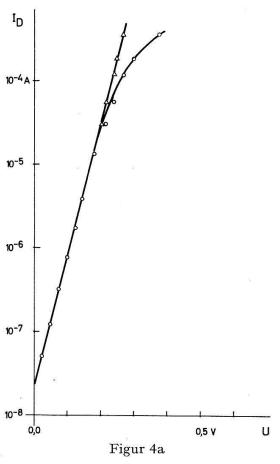
Diodenstrom, Leitrichtung (Diode Nr. 1)  $\bigcirc$  Messpunkte  $\triangle$  Korrigiert mit 280  $\Omega$  Seriewiderstand  $T=298^\circ$  K
