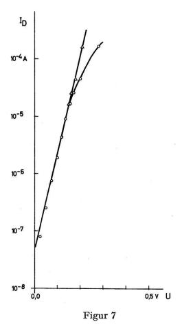
Diodenstrom, Leitrichtung (Diode Nr. 7)
