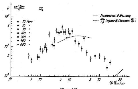
Figur 13b Diffusionskonstante in Methan
