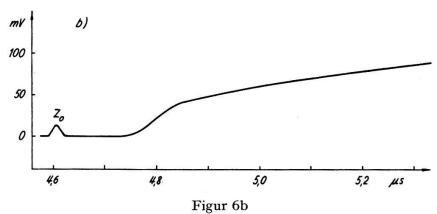
Nachgezeichnetes Oszillogramm der Ladung am Auffänger  $\int\limits_0^t I'(t)\ dt$  mit besserer Zeitauflösung bei Gasverstärkung >1
