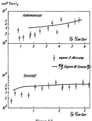
Figur 12 Diffusionskonstante in  $CO_2$  und  $N_2$
