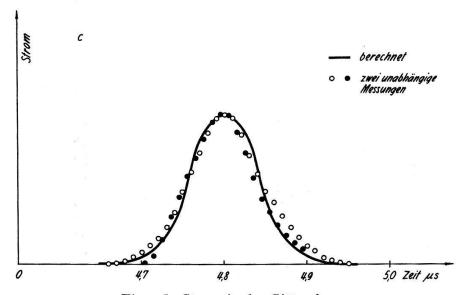
Figur 5c Strom in der Gitterebene
