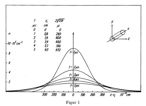
Berechnete Elektronendichte n in der Ebene y = 0 für  $CO_2$
