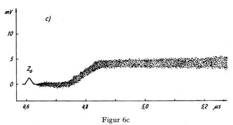
Nachgezeichnetes Oszillogramm der Ladung am Auffänger const  $\int\limits_0^t I(t) \ dt$ , erhalten durch Aufzeichnung der Ladung ohne Ionen (Gasverstärkung 1).  $z_0$ : Zeitmarken zur Anpassung der Kurven b und c
