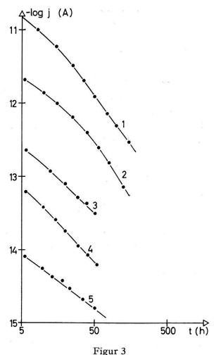
Zeitabhängigkeit des Stromes durch einen Kristall mit injizierenden Kontakten bei  $T=65\,^{\circ}$ C 1. U=1000 V, 2. U=600 V, 3. U=300 V, 4. U=150 V, 5. U=75 V
