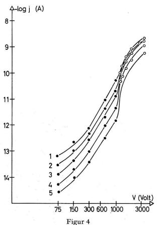
Strom-Spannungs-Verhalten desselben Kristalls wie in Figur 3 1. t = 5 h, 2. t = 10 h, 3. t = 25 h, 4. t = 50 h, 5. t = 100 h, (T = 65 °C)
