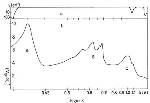
a) Absorption  $\varepsilon$  eines 1,5 mm dicken Einkristalles (Lichteinfall senkrecht zur ab-Ebene); b) Wellenlängenabhängigkeit des Stromes bei 20 °C (die Lichtintensität ist bei 0,5  $\mu$  etwa 100mal schwächer als bei 1,4  $\mu$ )
