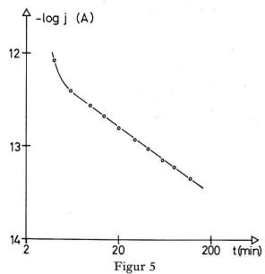
Strom durch einen Kristall mit sperrenden Kontakten Für t < 5 min. wird der Einfluss der Schaltkapazitäten bemerkbar
