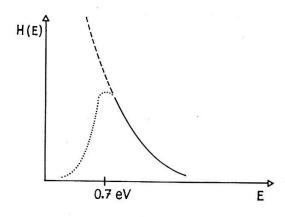
Figur 9 Mögliche reale Trap-Verteilung
