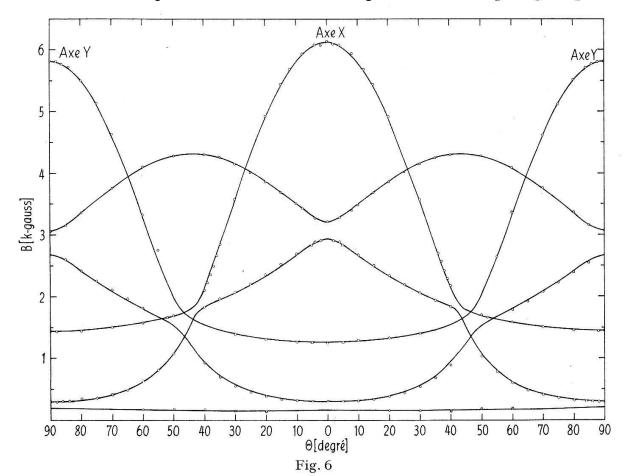
raies du spectre en fonction des angles caractérisant la direction considérée. On peut voir sur la figure 6 le spectre de rotation autour de l'axe z. L'accord entre le spectre théorique, indiqué par la ligne continue, et les points expérimentaux est tout à fait satisfaisant.
