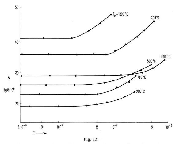
Frottement interne de WM 1 mesuré à  $100^{\circ}$ C en fonction de la déformation moyenne après des recuits de 4 heures effectués à températures croissantes.
