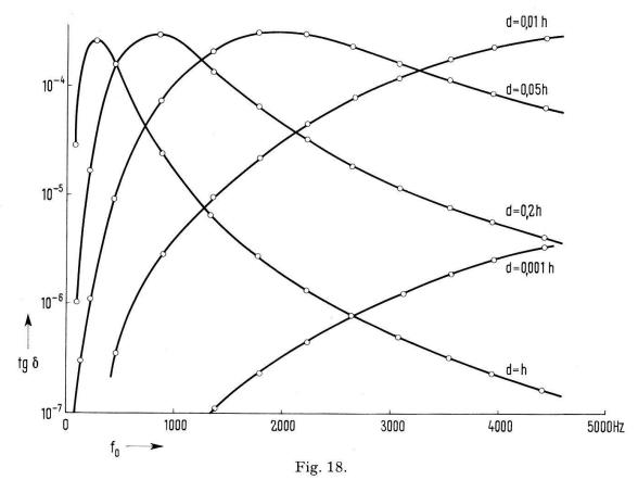
Frottement interne en fonction de la fréquence résultant du couplage thermo-élastique (d = diamètre du grain; h = hauteur de l'éprouvette).
