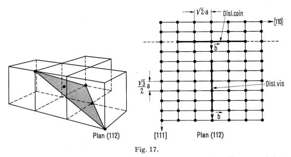
Représentation des dislocations du plan de glissement (112) à partir desquelles on peut s'attendre à observer l'effet de la formation de doubles décrochements thermiques.
