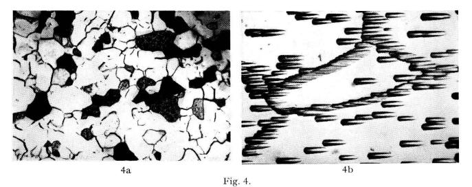
a) micrographie des grains révélés sur W 2 (1 cm  $\triangle$  10 microns), b) figures d'attaques et sous-grains révélés sur WM 1.
