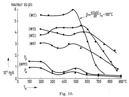
Hauteur des pics de frottement interne observés sur W 2, W 5, W 6 et WM 1 après des recuits de 4 heures effectués à températures croissantes.
