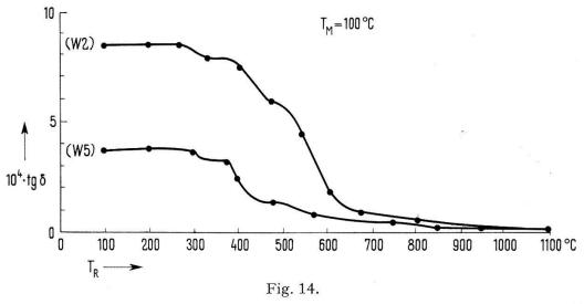
Frottement interne de W 2 et W 5 mesuré à 100°C après des recuits de 4 heures effectués à températures croissantes.
