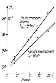
Figure 13 Calcul graphique des énergies de relaxation.  $T_m$  Température absolue de mesure
