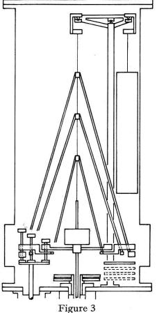
Le pendule à 4 disques d'inertie.
