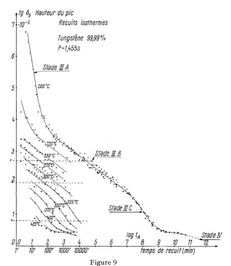
Etude de la restauration d'un pic de frottement interne créé par écrouissage et mesuré en pendule inversé.
