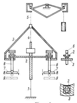
Figure 2 Schéma de principe du pendule à disques multiples.
