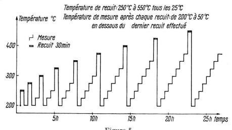
Figure 5 Programme d'un recuit isochrone.
