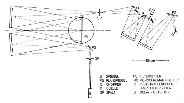
Strahlengang des Spektrometers bei Wasserdampf - Absorptionsmessungen
