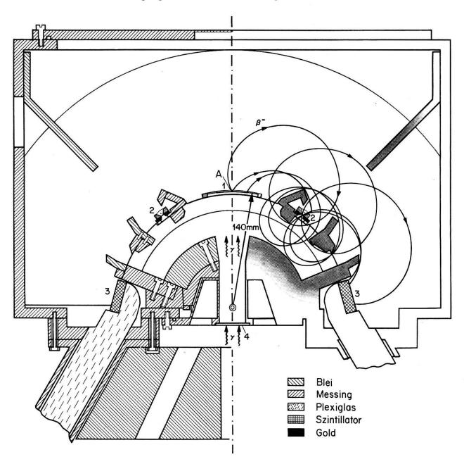
Fig. 1 Schnitt durch das Spektrometer.
