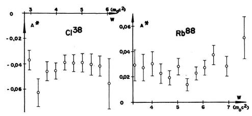
Corrélation directionnelle réduite 2–  $\beta$  2+  $\gamma$  0+ dans le Cl-38 et le Rb-88
