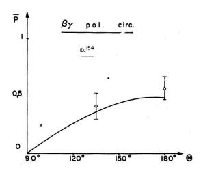
Corrélation  $\beta$  (1840 keV)  $\gamma$  (123 keV) polarisé circulairement intégrée sur l'énergie de la particule bêta depuis 1,0 MeV
