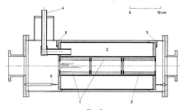
Figur 3 Ölabscheider im Targetrohr.
