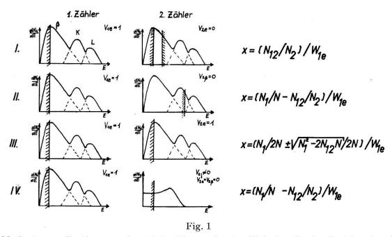
Vier Methoden zur Bestimmung des totalen Konversionskoeffizienten. In den Spektren bezeichnet  $\beta$  das Betaspektrum und K und L die Konversionselektronen.
