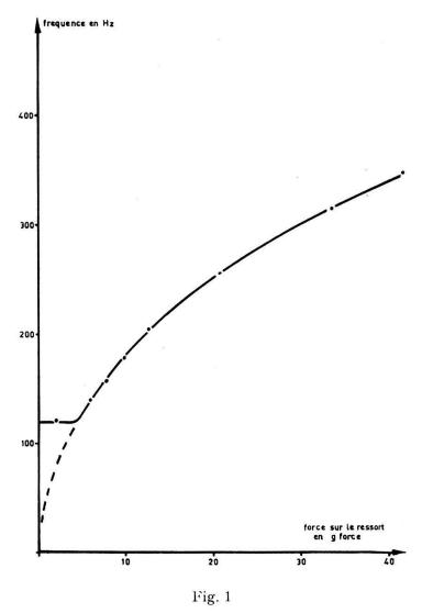
Fréquence de résonance d'une lame d'or soumise à une tension variable
