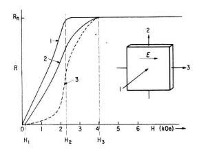
Partie réelle de l'impédance de surface R en fonction du champs magnétique appliqué H. Le numéro des courbes se rapporte à l'orientation de H. Ces mesures ont été faites par M. CARDONA et B. ROSENBLUM<sup>8</sup>) sur un alliage  $Pb_{0,5}$   $Tl_{0,5}$  à la température de  $4,2^{\circ}$  K.
