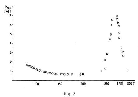
Resonanzfeld  $H_{res}$  als Funktion der Temperatur, v=110 MHZ,  $\square$   $H_{res} \parallel$  R,  $\bigcirc$   $H_{res} \perp$  R
