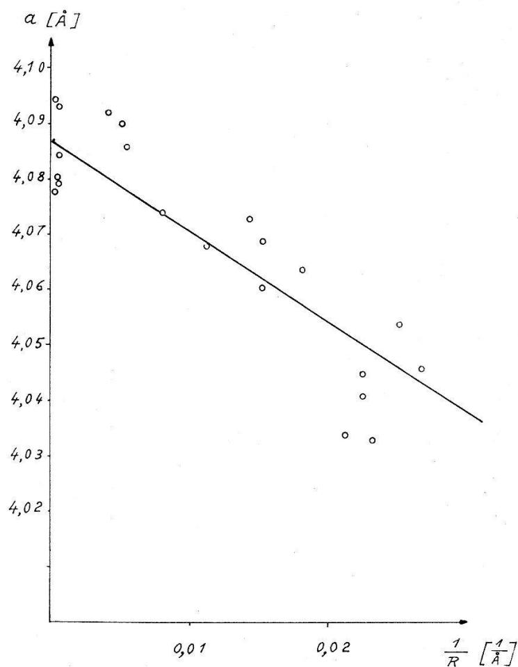
L'erreur finale sur la maille est de 2,4 à 5%. Nous n'avons pas fait de mesures sur des cristaux inférieurs à 60 Å de diamètre. Sur le graphique, les points d'abscisse  $1/R$  voisine de zéro, correspondant à des valeurs mesurées sur des lames épaisses, continues, conduisent à la valeur du paramètre de l'argent massif.
