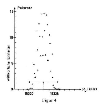
Pulsrate der Elektronen im Detektor als Funktion der Ablenkspannung
