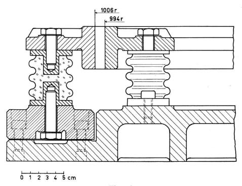
Figur 2 Schnitt durch das Ablenkplattensystem
