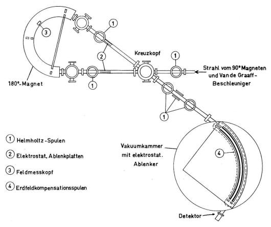
Figur 1 Messapparatur
