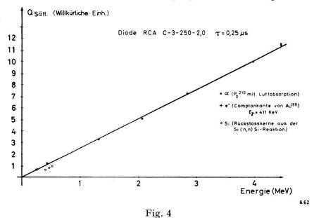
Energieabhängigkeit der Sättigungsladung in Si. Die Punktgrösse bedeutet gleichzeitig die Messfehler
