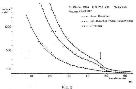
Impulsspektrum ohne und mit einem 15-cm-Polyäthylenabsorber. Die freie Weglänge von 3,9-MeV-Neutronen in Polyäthylen beträgt 4,0 cm. Die beiden experimentellen Kurven wurden durch Bestrahlung mit der gleichen (unabgeschwächten) Neutronendosis erhalten. Der Pfeil zeigt die Lage der Wendetangente an
