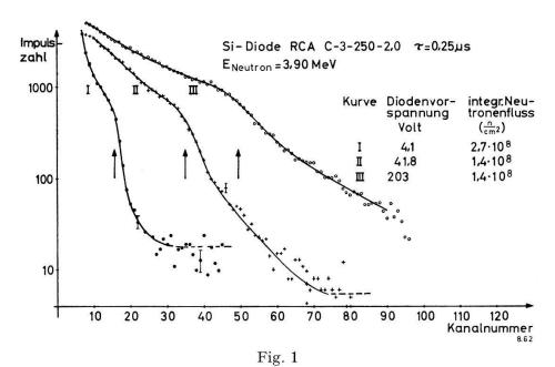
Impulsspektrum bei Bestrahlung einer RCA-Diode mit 3,9-MeV-Neutronen. Die eingezeichneten Fehler sind die statistischen. Die Pfeile zeigen die Lage der in einer linearen Darstellung auftretenden Wendetangente an
