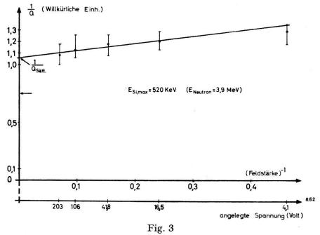
Sättigungskurve für die aus Figur 1 erhaltenen Impulshöhen (Ladungen). In den eingezeichneten Fehlern wurde das stark verschmierte Impulsspektrum berücksichtigt. Auf der Abszisse sind die Werte  $(V_{Diode}+0,4)^{-1/2}$  aufgetragen, welche proportional zur reziproken Feldstärke sind.
