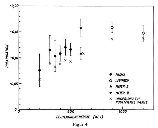
Polarisation der d, d-Neutronen für dünnes Target. Messungen von Pasma<sup>15</sup>, <sup>16</sup>), Levintov et. al. <sup>17</sup>), und Meier et. al. <sup>13</sup>). I mit Phasen von Meier et. al. <sup>13</sup>), II mit Phasen von Wills et. al. <sup>14</sup>) berechnet.
