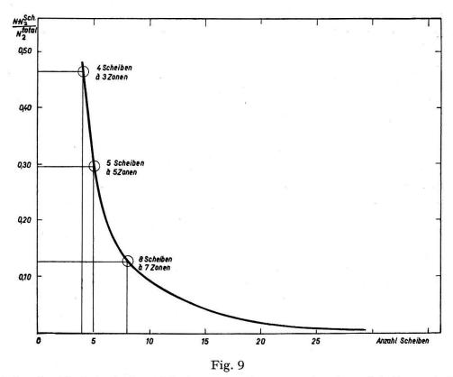
In Figur 9 ist das Verhältnis der N-fachen Doppelstreuung in einer Scheibe und der totalen Doppelstreuung in Abhängigkeit der zunehmenden Verfeinerung der Einteilung des Streukörpers in Scheiben aufgetragen.
