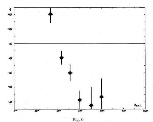
In Figur 6 sind die gemessenen Werte  $P_2$  für Zirkon in Funktion des Streuwinkels  $\theta_{LS}$  aufgetragen. Sie sind auf Grund der in Kapitel 2 behandelten Störeffekte korrigiert.
