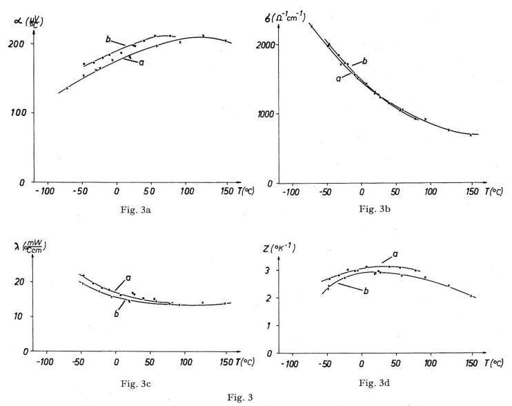
a) Thermokraft  $\alpha$ , b) elektrische Leitfähigkeit  $\sigma$ , c) Wärmeleitfähigkeit  $\lambda$  und d) Effektivität z zweier Proben von  $(\mathrm{Bi}_{0,5}\mathrm{Sb}_{1,4}\mathrm{Te}_{0,1})$   $(\mathrm{Te}_{2,875}\mathrm{Se}_{0,125})$ .
