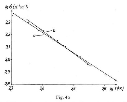
a) Thermokraft  $\alpha$  in Abhängigkeit vom Logarithmus der Temperatur, b) Logarithmus der elektrischen Leitfähigkeit  $\sigma$  in Abhängigkeit vom Logarithmus der Temperatur.
