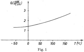
Korrekturglied G für die Messung der Wärmeleitfähigkeit in Abhängigkeit von der Temperatur.
