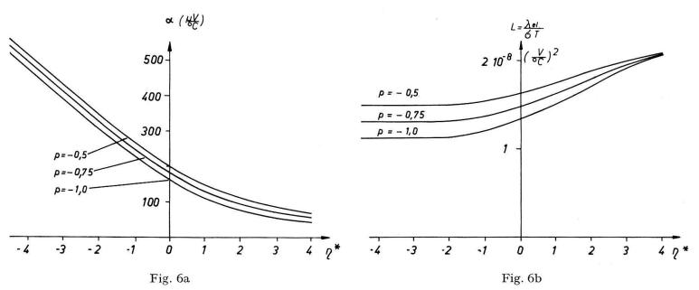
a) Thermokraft  $\alpha$ , b) Lorentz-Verhältnis  $L=\lambda e l/\sigma T$  in Abhängigkeit von der reduzierten Fermi-Energie  $\eta^*$  nach Gleichung (3) und (1) für p=-0.5, p=-0.75 und p=-1.0. (Für p=-0.75 interpoliert).
