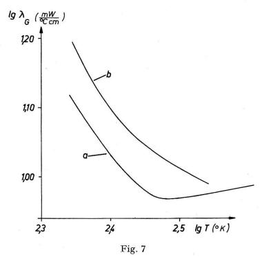
Berechnete Gitterwärmeleitfähigkeit  $\lambda_g$  der Proben a und b.
