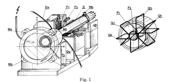
Anordnung der Ferranti 5/74 QM-Röhre. Die wichtigsten Zubehörteile sind:  $F_1$  = Fokussierspule,  $F_2$  = Fokuskorrekturspule,  $D_x$  +  $D_y$  = Ablenkring (max.  $\pm$  30°, L/R je ca. 1 msec).  $F_1$  ist relativ zur Röhre 5fach verstellbar,  $F_2$  und D sitzen fest auf dem Röhrenhals.
