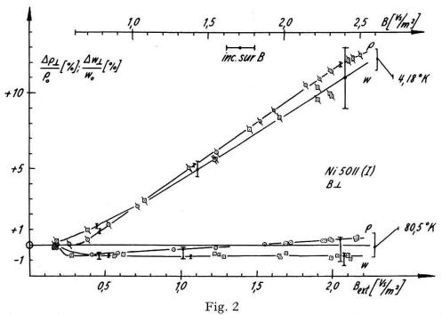
Variation en champ magnétique transversal de la résistivité électrique et de la résistivité thermique du nickel Ni 5011 (I)
