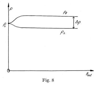
Définition expérimentale de l'anisotropie ferromagnétique de la résistivité électrique
