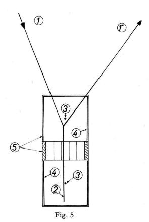
Querschnitt durch ein Zählrohrpaar;
