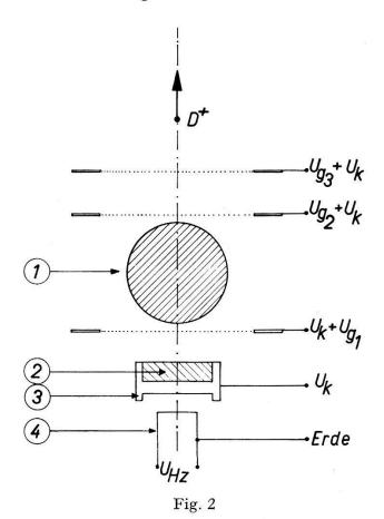
Schematischer Aufbau der Elektronen-Kanone;
