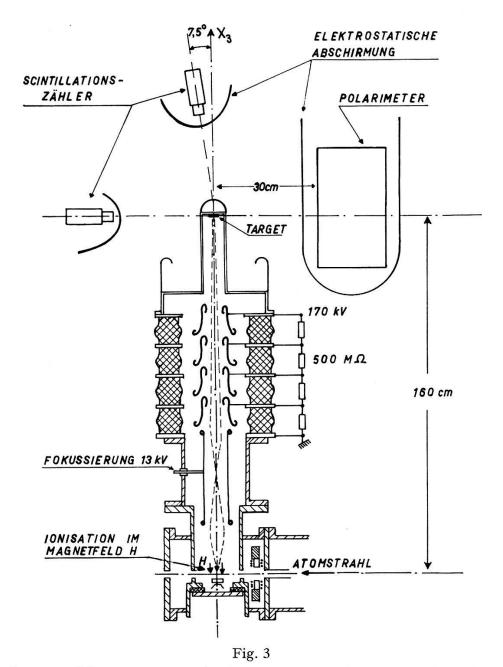
Anordnung zur Messung von Polarisation und Anisotropie der Winkelverteilung der Neutronen.
