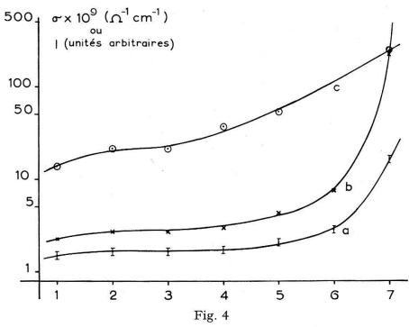
Conductivité et intensité luminescente pour 7 cristaux de pureté décroissante. Les courbes a et b donnent  $\sigma$  resp.  $\sigma^2$  et la courbe c l'intensité I de la composante «chaude».
