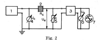
Dispositif de mesure de  $\sigma$
