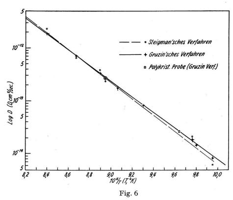
Selbstdiffusionskonstante D in Abhängigkeit des Kehrwertes der absoluten Temperatur T.
