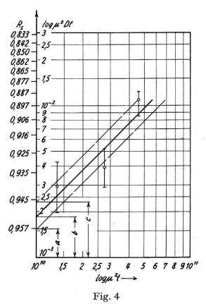
Strahlungsabnahme  $R_s$  an der Probenoberfläche in Abhängigkeit von der Glühzeit t (Steigmansches Verfahren, Messung Nr. 2), Temperatur 829,5°C = 1102,7°K
