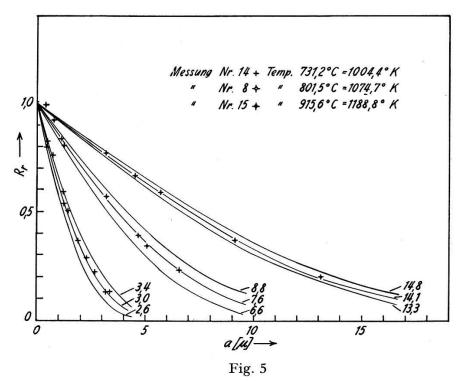
Strahlungsabnahme  $R_r$  an der Probenoberfläche in Abhängigkeit von der Dicke a der abgehobenen Schicht (Gruzinsches Verfahren). Die an die Kurven angeschriebenen Parameter sind die Diffusionstiefen 2  $\sqrt{D\tau}$  in  $\mu$ .
