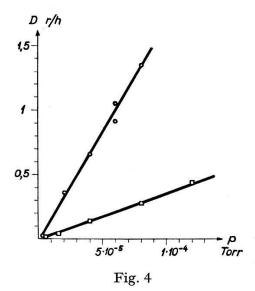
Röntgenstrahlleistung D in 1 m Abstand vom Beschleunigungsrohr als Funktion des Gasdruckes im Rohr. Betrieb bei 2 MV und 40  $\mu$ A Protonenstrom.
