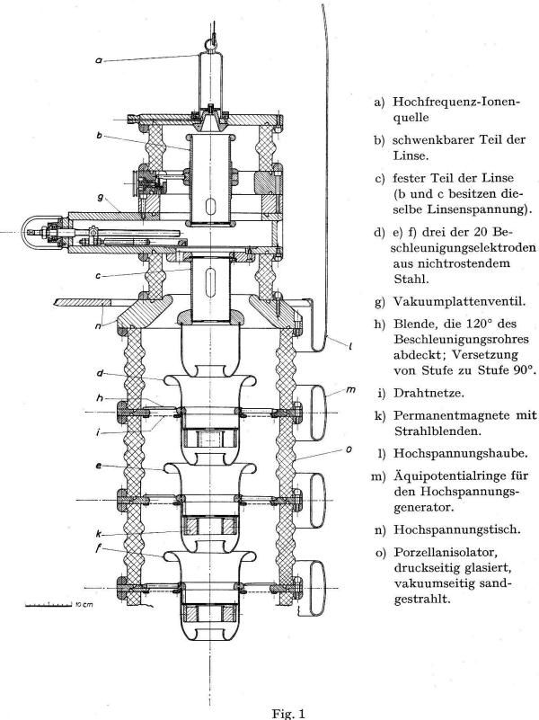
Querschnitt durch den oberen Teil des Beschleunigungsrohres
