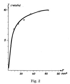
Strahlprofil bei Fokussierung auf ein Target in 1,5 m Entfernung vom unteren Beschleunigungsrohrende. Aufgetragen ist der durch eine quadratische Fläche F hindurchtretende Strom I.
