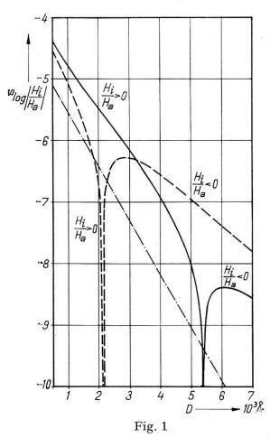
Verhältnis der inneren zur äusseren Feldstärke  $H_i/H_a$ in Funktion der Schichtdicke D. Radius des Hohlzylinders R=1 cm.
