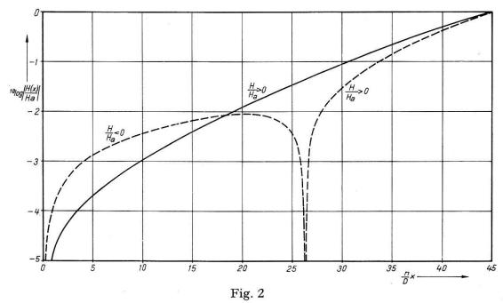
Ortsabhängigkeit des Magnetfeldes H(x) in der Wand des Hohlzylinders.  $H_a=$  angelegtes äusseres Magnetfeld; Wandstärke D=6000 Å, Anzahl der Teilintervalle n=45, Radius des Hohlzylinders R=1 cm.
