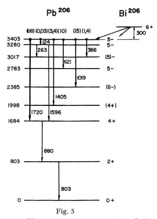
Partielles Zerfallsschema von <sup>206</sup>Bi nach Alburger und Pryce<sup>2</sup>). Energien in keV; Gammaintensitäten in Klammern (nach Tab. 3).
