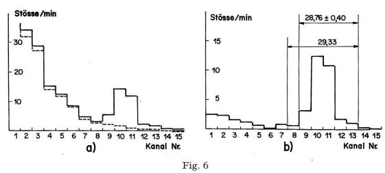
Spektren im 20-Kanal-Impulsanalysator (1. K-Linienmessung, J=4,150 Amp) a) Ausgezogene Linie: ohne Plexiglasabsorber; unterbrochene Linie: mit Plexiglasabsorber.
