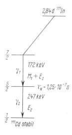
a Zerfallschema von <sup>111</sup>In. Der radioaktive Kern <sup>111</sup>In zerfällt durch Einfang eines Elektrons aus der K-Schale des Atoms in einen angeregten Zustand des Kerns <sup>111</sup>Cd. Dieser zerfällt durch sukzessive Emisssion von zwei  $\gamma$ -Quanten in den Grundzustand. Die beiden  $\gamma$ -Quanten folgen einander sehr rasch, die Lebensdauer  $\tau_N$  des mittleren Niveaus der  $\gamma$ -Kaskade beträgt nur  $1,25\cdot 10^{-7}$  s.
