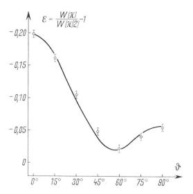
b Anisotropie  $\varepsilon = W(\pi)/W(\pi/2) - 1$  als Funktion des Winkels  $\vartheta$  zwischen Kristallachse c und dem ersten  $\gamma$ -Strahl  $k_1$
