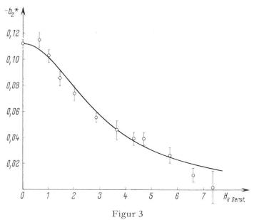
Beispiel einer Messung eines magnetischen Momentes (111Cd).  $b^* = b_2 g_2$  der RK-Funktion  $W(\vartheta) = 1 + b_2 \cdot g_2 \cos 2 \vartheta$  ist aufgetragen als Funktion des Magnetfeldes ([13] Figur 10).
