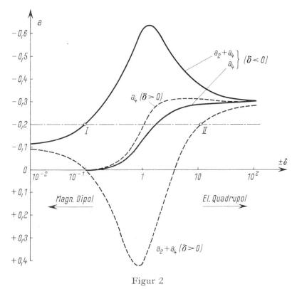
Beispiel einer Bestimmung eines Mischungsverhältnisses (\$^{111}Cd). Aufgetragen sind  $a_2+a_4$  und  $a_4$  der Funktion  $W(\vartheta)=1+a_2\cos^2\vartheta+a_4\cos^4\vartheta$  als Funktion des Mischungsverhältnisses  $\delta$  im ersten  $\gamma$ -Strahl ( $\delta^2=$  Intensität E2/Intensität M1). Der zweite  $\gamma$ -Strahl ist reine elektrische Quadrupolstrahlung E2. Zerfallsschema siehe Figur 1 ([8], Figur 2).
