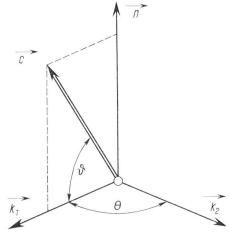
a Schematische Darstellung der experimentellen Anordnung.  $k_1$  und  $k_2$  sind die Richtungen der emittierten  $\gamma$ -Strahlen, c die Richtung der Symmetrieachse des tetragonalen Indiumkristalles, n die Normale zur Zählerebene  $k_1$ ,  $k_2$
