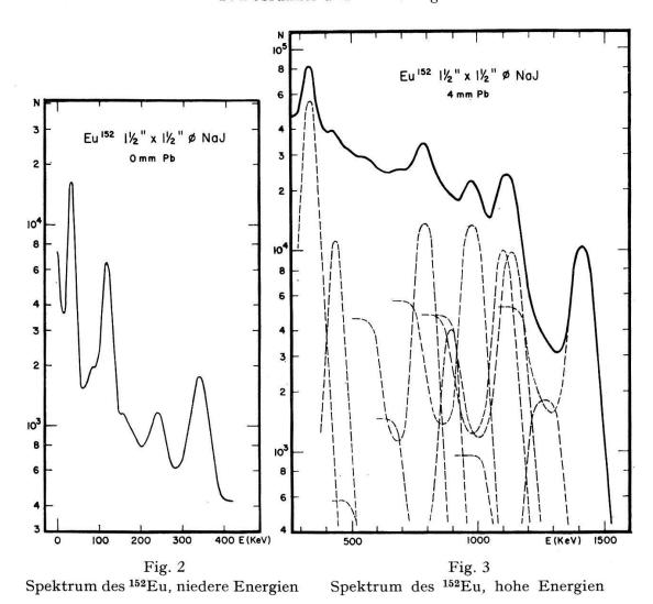
nahme, dass die eine Komponente mit der im 122-KeV-Koinzidenzspektrum auftretenden Linie identisch ist. Zwischen 700 KeV und 500 KeV müssen weitere Linien mit einer Gesamtintensität von (15) angenommen werden.
