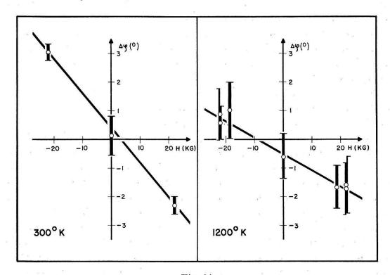
Fig. 11 Verschiebung  $\Delta \varphi$  der Winkelverteilung  $W(\Theta, H) = W(\Theta + \Delta \varphi)$  im Magnetfeld H bei 300° K und 1200° K (152Eu, Oxydquelle)
