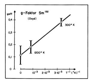
Fig. 12 Effektiver g-Faktor  $g_{\rm eff}$  in Funktion von  $T^{-1}$  Der bei  $T=\infty$  eingezeichnete Wert ist nach (15) aus den Messwerten bei 300° K
