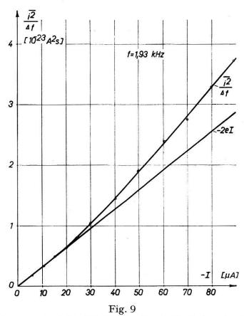
Rauschstromquadrat der TP 50, Nr. 20, als Funktion des Stromes. Mittlere Messfrequenz f=1.93 kHz, Sperrspannung U=-10 V.  $I=-(I_0+I_p)$ .
