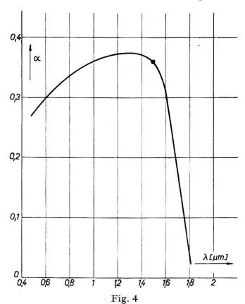
Verlauf des Quantenwirkungsgrades  $\alpha$  über die Lichtwellenlänge  $\lambda$ . Kurve nach Datenblatt der TP 50, normiert auf den Wert 0,36 bei  $\lambda=1,49\,\mu\text{m}$ , gemessen an der TP 50, Nr. 20.
