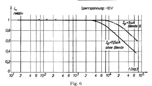
Relative Frequenzempfindlichkeitskurve der TP 50. Sperrspannung U = -10 V, Modulationstiefe 100%, Belastung praktisch Kurzschluss. Messung mit Blende in optimaler Stellung und ohne.
