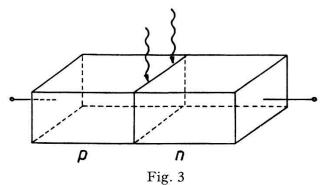
Prinzip des Aufbaues einer TP 50. Das Licht fällt seitlich auf die Sperrschicht.
