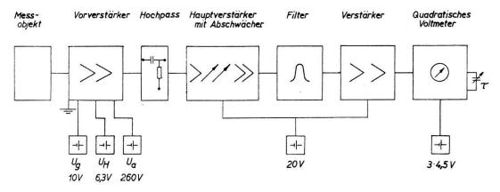
Fig. 7 Blockschema der Rauschmessanlage.
