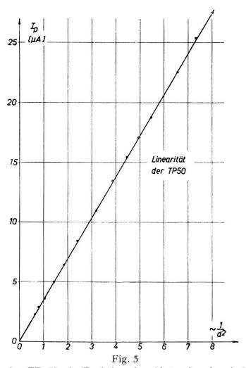
Photostrom  $I_p$  der TP 50 als Funktion des Abstandes d zwischen Lampe und Photodiode.
