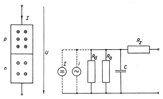
Fig. 1. Positiv gewählte Spannungs- und Stromrichtungen an der TP 50.
