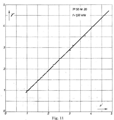
Schwankungsfaktor des Diodenstromes  $\gamma$  als Funktion des Schwankungsfaktors der auf die idealisierte Diode auftreffenden Strahlung  $\mu'$ .
