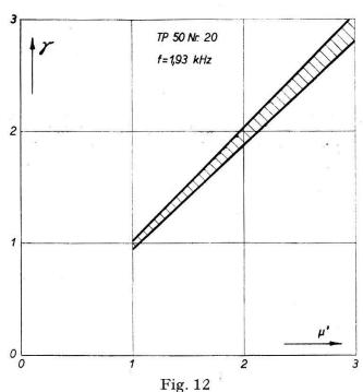
Darstellung der Messung  $\gamma(\mu')$  unter Berücksichtigung der grössten möglichen Messfehler. Die wahren Werte liegen innerhalb des schraffierten Gebietes.
