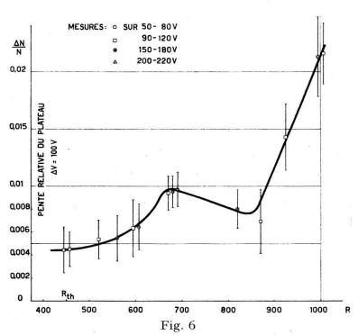
Compteur III. a=0.18 mm; D=50 mm; c=3.0 mm; d=+2 mm. Irradiation par Co<sup>60</sup> avec collimation. Pente du plateau en fonction de R.
