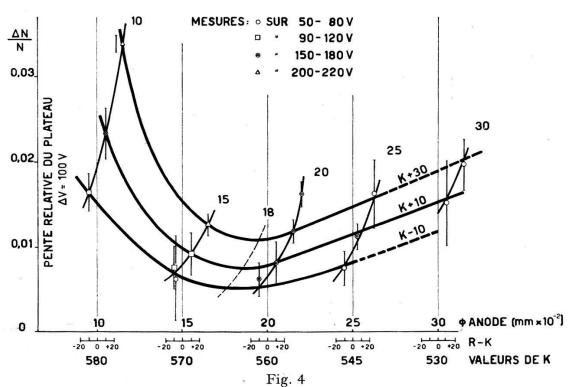
Compteur II. D=80 mm; d=-2 mm; c=3.0 mm. Irradiation par  $\mathrm{Co^{60}}$  avec collimation. Pente du plateau en fonction de R et de a.
