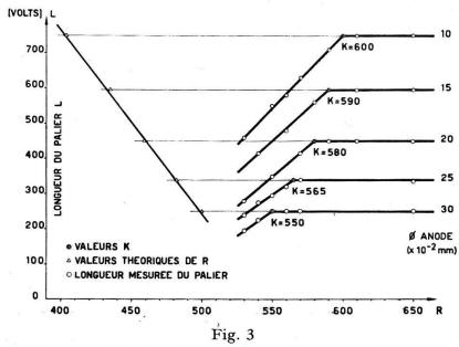
Compteur II. D=80 mm; d=-2 mm; c=3.0 mm. Longueur du palier en fonction de R pour différents diamètres de l'anode.
