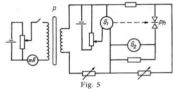
Schaltung zur ballistischen Messung der Induktion P= Probe,  $G_1$ ,  $G_2=$  Primär- und Sekundärgalvanometer, Ph= Sperrschichtphotozelle
