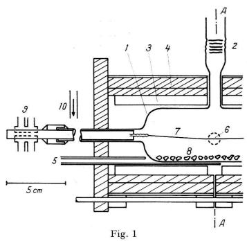
Schnitt durch das Reaktionsgefäss. Das System ist bezüglich AA symmetrisch 1 Quarzrohr, 2 Quarz-Pyrex-Verbindung, 3 Heizelemente, 4 Isolation, 5 Thermoelemente (Chromel-Alumel), 6 Pyrometeröffnung, 7 Wolframfaden, 8 Ausgangsmetall, 9 Stromzuführungen mit Wasserkühlung, 10 Luftkühlung
