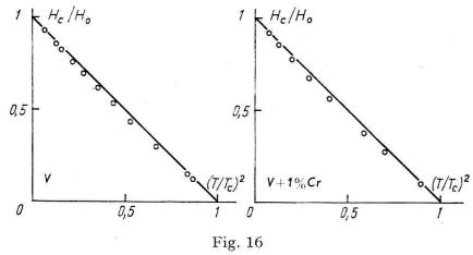
Temperaturabhängigkeit der kritischen Felder Die Gerade entspricht  $H_c/H_0=1-(T/T_c)^2$
