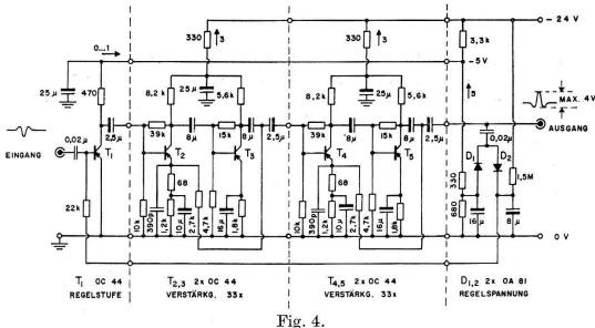
Transistorenverstärker mit automatischer Pegelregulierung. Die 2<br/>stufigen Einheiten von je 33 facher Verstärkung haben eine Eingangsimpedanz von 8 k<br/>  $\Omega$ parallel mit 50 pF und eine Ausgangsimpedanz von 40  $\Omega$  <br/>in Serie mit 40  $\mu{\rm Hy}.$  Die 390 pF-Kondensatoren müssen in jeder Einheit individuell den jeweiligen Transistoren angepasst (evtl. ganz weggelassen) werden.
