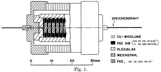
Schnitt durch eine aus 12 Spulen bestehende elektroakustische Impulswandleranordnung. Bei Verwendung von Ni- oder Stahldrähten als akustische Leiter beträgt die Zeitdifferenz zwischen aufeinanderfolgenden Spulen etwa 0,35  $\mu$ sec. Die Vormagnetisierringe FXD 56,590.78/15C sind nur bei empfangsseitiger Anwendung erforderlich.
