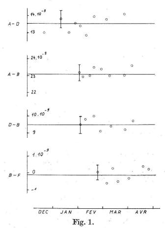
Comparaison de fréquence entre 4 Maser en fonction du temps.
