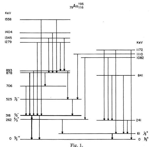
Niveauschema von Au<sup>195</sup>. Links aufgeführte Energien bedeuten Niveaux, die vom Isomer in Hg<sup>195</sup> aus angeregt werden; rechts aufgeführte solche vom Grundzustand her.
