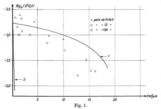
Longueur moyenne de lacunes relative au plateau,  $G^*$ , en fonction de l'écartement des paires d'électrons  $y_{\mu m}$ . Valeurs calculées sur la base du modèle tridimensionnel de formation des traces: courbe 1; de l'effet dipôle: courbe 2.
