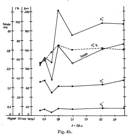
Magnetstrom: 0,8 A, Gasverbrauch ca. 2 cm³/h, Druck ca. 10<sup>-3</sup> mm Hg. Bemerkenswert ist der kleine Leistungsbedarf:
