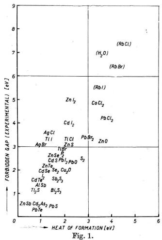
Zuordnung des experimentell bestimmten Bandabstandes zu der Bildungswärme aus dem Normalzustand der Elemente (für S<sub>2</sub>, J<sub>2</sub>, Se<sub>2</sub> und P<sub>2</sub> aus der Gasphase).
