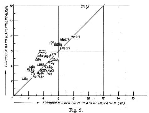
Zuordnung des experimentell bestimmten Bandabstandes zu dem mittels der Hydratationswärmen der Einzelionen berechneten Bandabstand.
