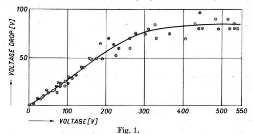
Abhängigkeit des Spannungsabfalls von der Anfangsspannung nach Belichtung mit 7.10<sup>11</sup> Lichtquanten/cm<sup>2</sup> der Wellenlänge 3680 Å.
