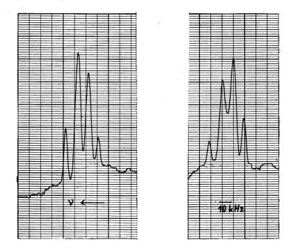
Fig. 2. Inversionsspektrum des  $\mathrm{NH_3}$ ; magnetische Satelliten ( $\Delta F_1=0$ ;  $\Delta F=\pm 1$ ) der Linie J=K=3.
