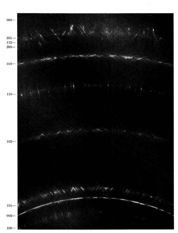
${\bf Fig.~2.}$  Feinstrahlbeugung an ZnO bei 50 kV Elektronengeschwindigkeit.
