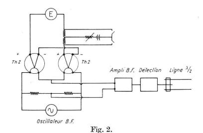
A la sortie des thermocouples, il apparaı̂t les tensions  $e_1$  et  $e_2$  respectivement.
