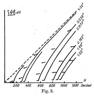
ballistischen Ausschlages über einen empfindlichen photoelektrischen Verstärker. Die Temperatur war unterhalb  $4,17^{\circ}$  K auf  $0,001^{\circ}$  und oberhalb  $4,17^{\circ}$  K auf  $0,01^{\circ}$  stabilisiert. An den verschiedenen Proben wurden im Feld 0 Sprungpunkte zwischen 5,28 und  $5,30^{\circ}$  K gemessen.
