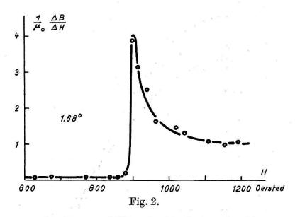
Die Messung der Permeabilität in Funktion der Temperatur und des longitudinalen Magnetfeldes erfolgte durch Einschalten eines kleinen Zusatzfeldes von 5 bis 10 Oersted und Beobachtung des
