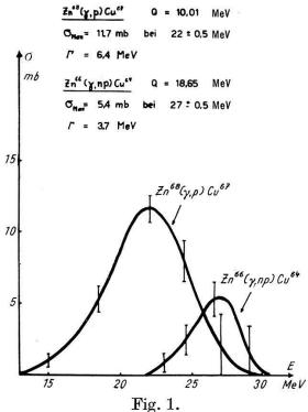
Wirkungsquerschnittsverlauf der Reaktionen  $Zn^{66}(\gamma,np)Cu^{64}$  und  $Zn^{68}(\gamma,p)Cu^{67}$ . mit Gammaanregung gemessen. Ältere Messungen<sup>2</sup>)<sup>3</sup>) des integrierten Querschnittes der  $Zn^{66}(\gamma,np)Cu^{66}$  und  $Mo^{92}(\gamma,np)Nb^{90}$  mit Hilfe eines 70 MeV Synchrotons geben Werte, die analog wie die (p,pn)-Reaktionen nicht mit der stat. Theorie erklärt werden können.
