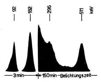
Fig. 1.  $\gamma$ -Spektrum von  $Cu^{67} + Cu^{64}$ .
