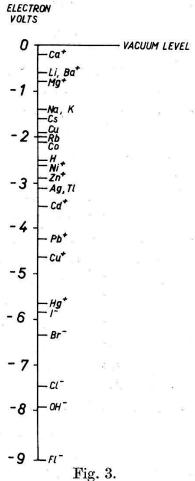
Energieniveaux gegenüber Vakuum von in Wasser eingetauchten Ionen. Es ist die Arbeit (in eVolt) angegeben, die aufzuwenden ist, um von dem Element im angegebenen Ionisierungszustand ein weiteres Elektron ins Vakuum zu bringen.
