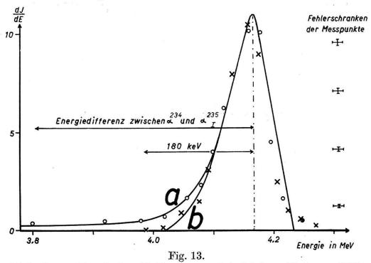
Linienform mit und ohne Kollimator am Beispiel der  $\alpha$ -Linie von U<sup>238</sup>. Kurve a zeigt die Linienform ohne Kollimator unter Berücksichtigung von Widerstandsrauschen und Selbstabsorption in der Quelle, Kurve b dasselbe mit Kollimator. Die Punkte sind gemessen, die Kurven sind berechnet. Die gemessene Halbwertsbreite der Linie beträgt 1,8%.  $\circ$  Messpunkte ohne Kollimator.  $\times$  Messpunkte mit Kollimator.
