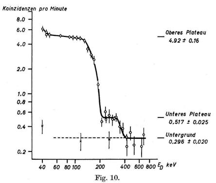
$\alpha$ - $\gamma$ -Koinzidenzen des U<sup>235</sup> in Abhängigkeit von der Diskriminierung im  $\gamma$ -Kanal.  $E_D$  ist die Energie der Compton- oder Photoelektronen, bei der im  $\gamma$ -Zähler diskriminiert wird.
