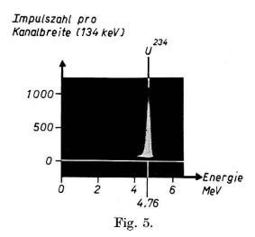
Gesamt α-Spektrum des angereicherten Uranpräparates. Nur die U<sup>234</sup>-Linie erscheint. (2400 Impulse, Expositionszeit 4,5 Min.).
