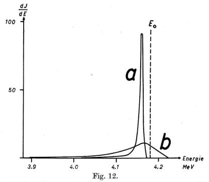
Berechnung der Linienform und der Lage des Maximums einer monochromatischen  $\alpha$ -Linie der Energie  $E_0$ . Berücksichtigt wurde der Einfluss der Feldinhomogenität im Kollimator (Kurve a), des Widerstandsrauschens und der Selbstabsorption in der Quelle (Kurve b). Die Intensität (J) der beiden Linien unter den Kurven a und b ist gleich gross. Als Beispiel dient die  $\alpha$ -Linie von  $U^{238}$ .
