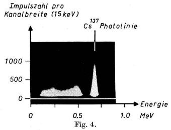
Spektrum der Cs<sup>137</sup>-γ-Strahlung, registriert mit Hilfe eines NaJ(Tl)-Szintillationszählers (11400 Impulse, Expositionszeit 1,9 Min.). Testaufnahme zur Prüfung der Photokathode des auf der α-Seite verwendeten Multipliers.
