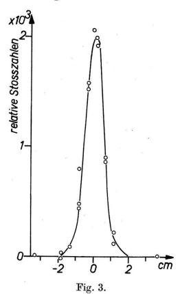
Neutronenverteilung hinter dem Kollimator am Orte der Kammer, gemessen mit einem Hornyak-Detektor von 1 cm Durchmesser. Die Verteilung ist nicht auf unendlich kleine Detektorausdehnung reduziert.
