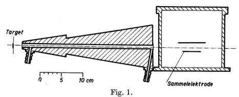
Neutronenkollimator und dessen Lage bezüglich Ionisationskammer und Target.
