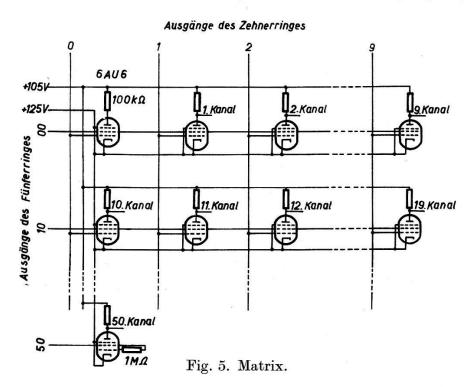
Jedem Ausgang der Matrix ist ein achtfacher Untersetzer mit einem mechanischen Zählwerk angeschlossen. Die Untersetzung ist von achtfacher auf zweifache Untersetzung umschaltbar, indem bei den ersten zwei Scalestufen je einem Steuergitter eine negative Spannung aufgedrückt wird, so dass die Stufe den Eingangsimpuls auf die nächste überträgt, ohne zu kippen.
