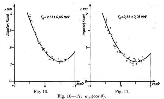
O: Messpunkte; ausgezogene Kurve: nach den Phasen von Dodder und Gammel<sup>13</sup>) berechneter Streuquerschnitt.
