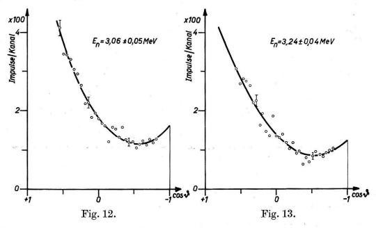
die Stosszahlen pro Kanal linear aufgetragen. Die Abszisse trägt die cos-Werte des Streuwinkels im Schwerpunktsystem. Für einige Messpunkte sind als Beispiel die statistischen Fehler eingetragen. Bei 3,57 und 3,67 MeV Neutronenenergie ist die Messgenauigkeit
