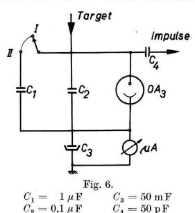
Stellung I:1  $\mu$ A entspricht 16 Impulsen/Minute. Stellung II:9  $\mu$ A entspricht 16 Impulsen/Minute.
