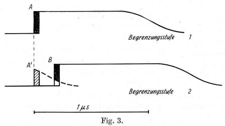
Störung der Funktion der Begrenzungsstufe durch einen kleinen, zeitlich korrelierten Impuls.
