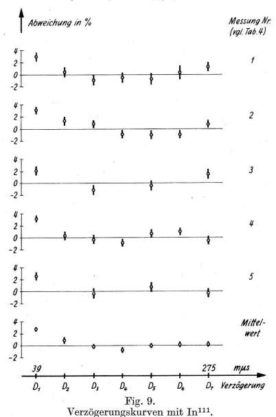
Aufgetragen ist die relative Abweichung der Messpunkte von derjenigen Exponentialfunktion, die als beste aus der Summe aller Messungen, unter Weglassung des unsicheren Punktes  $D_1$ , folgt. Die angegebenen Fehlergrenzen bedeuten mittlere Fehler.
