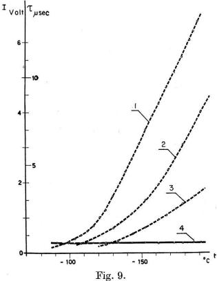
Kurve 1: Intensität als Funktion der Temperatur; Material aus wässriger Lösung kristallisiert.
