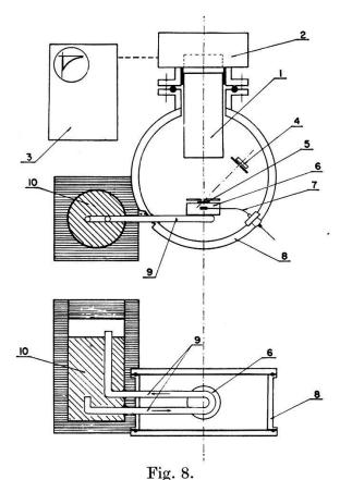
Querschnitt durch die Apparatur zur Messung von Abklingzeit und Intensität in Abhängigkeit von der Temperatur.
