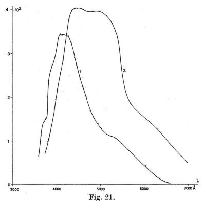
Emissionsspektren des Präparates von Fig. 17 (Druckschmelze); 1: 2410 Å; 2: 3000 Å UV.
