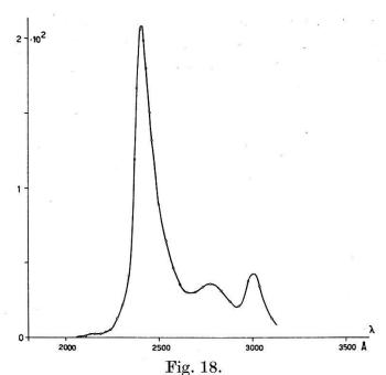
Anregungsspektrum von CsJ Harshaw, an der Luft 2 Minuten auf 800—900° C erhitzt.
