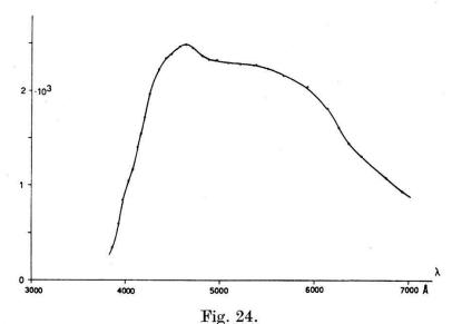
Emissionsspektrum der Druckschmelze bei  $e^-$ -Anregung.
