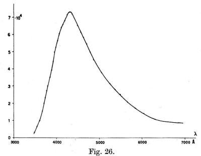
Nachgereinigtes Material, aus wässeriger Lösung kristallisiert; Emissionsspektrum bei  $e^-$ -Anregung;  $-180^{\circ}$  C.
