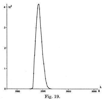
Anregungsspektrum von nachgereinigtem CsJ; Vakuumschmelze.
