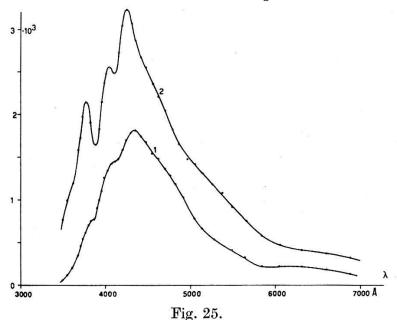
Emissionsspektrum der Vakuumschmelze für e-Anregung;
