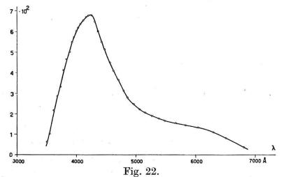
Emissionsspektrum der Vakuumschmelze bei 2410 Å UV.
