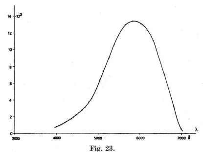
Emissionsspektrum von CsJ(Tl) (Einkristall von Harshaw) bei Anregung mit 45 keV Elektronen.
