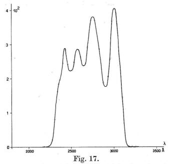
Anregungsspektrum von nachgereinigtem Material, in abgeschmolzenem Supremaxrohr einige Minuten auf  $800-900^{\circ}$  C erhitzt.
