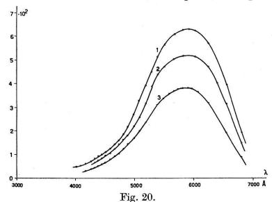
Emissionsspektrum von CsJ(Tl) (Harshaw) bei UV-Anregung mit den Wellenlängen 3000, 2750 und 2400 Å (bzw. Kurven 1, 2, 3).
