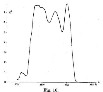
Anregungsspektrum von CsJ(Tl) (Harshaw); im Vakuum auf 800—900° C erhitzt.
