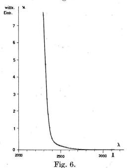
Absorptionsspektrum des nachgereinigten Materials (dünne Schicht zwischen Quarzplatten).
