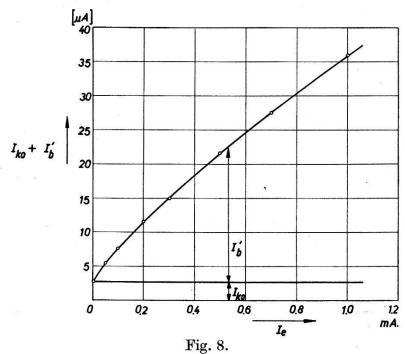
Sättigungsstrom  $I_{k_0}$  der Kollektorsperrschicht und Verteilungsstrom  $I_{b'}$  als Funktion des Emissionsstromes  $I_{e}$ , gemessen an einem Flächentransistor OC 70. Die Spannung des Kollektors gegen die Basis beträgt  $-2 \text{ V. } I_{b'}$  ist der zur Basis fliessende Anteil des Emissionsstromes.
