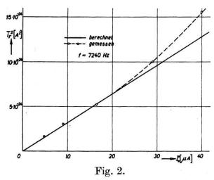
Mittleres Schwankungsstromquadrat  $\overline{i_r^2}$ , umgerechnet auf 1 Hz Bandbreite, in Abhängigkeit von  $I_0'$  bei einer mittleren Frequenz von 7240 Hz. Der Sperrstrom  $I_0'$  wird durch Belichtung der Sperrschicht verändert. Als Sperrschicht wurde eine solche eines Transistors des Typus OC 71 verwendet, welche in der Sperrichtung mit  $|eU| \gg kT$  betrieben wurde. Kreise: Messpunkte. Kurve berechnet nach Gl. (3).
