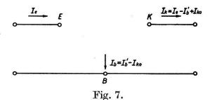
Ströme bei einem p-n-p-Flächentransistor, der als Vierpol geschaltet ist.
