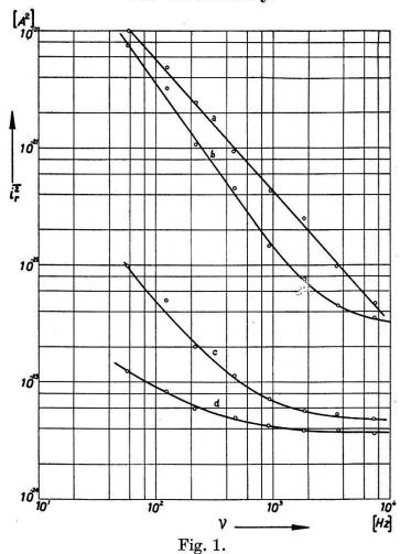
Mittleres Quadrat des Schwankungsstroms, umgerechnet auf 1 Hz Bandbreite,
