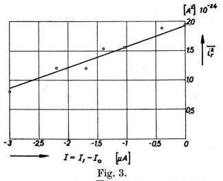
Mittleres Schwankungsstromquadrat  $\overline{i_r^2}$  einer Sperrschicht (Transistor OC 71) umgerechnet auf 1 Hz Bandbreite als Funktion des Stromes I durch die Sperrschicht. Kreise gemessen, Kurve nach Gleichung (3) berechnet. Der Stromanteil  $I_0$  ist  $3~\mu\mathrm{A}$ . Mittlere Messfrequenz 7240 Hz.
