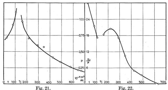
Les grandeurs P et  $R_1/P$  au voisinage du point de Curie. Echantillon Ni 30, état  $\gamma$ . (Détails dans le texte.)
