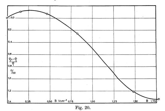
Variation relative de la résistivité  $(\varrho \perp - \varrho)/\varrho$  en fonction de l'induction magnétique B. (Alliage Ni 31 à 30° C.)
