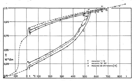
Fig. 6. Résistivité  $\varrho$  en fonction de la température t. Alliage Ni 30.
